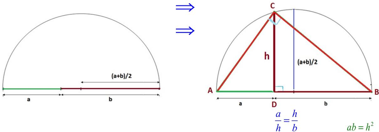
Les deux triangles ADC et DBC sont semblables. Il en découle que  $\frac{a}{h} = \frac{h}{b}$  ou encore  $ab = h^2$ . D'où
