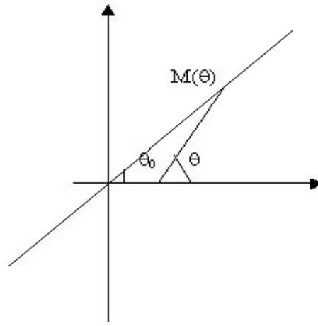
Équation polaire d'un cercle  $\mathcal{C}(\omega, R)$  passant par l'origine. Elle est de la forme  $\rho(\theta) = 2R \cos(\theta - \theta_0)$  où  $\theta_0$  l'angle que fait le vecteur  $\vec{O\omega}$  avec l'axe  $(ox)$ .
